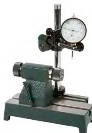
Abb. zeigt Reitstock mit drehbarer Spannzangeneinrichtung
