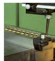
Beim Positionieren der Arbeitsspindelachse an der Werkzeugkante
