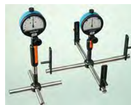
Kreuzhülse ab \varnothing 130 mm für Zentrieransätze oder Messung mit Tiefenanschlag
