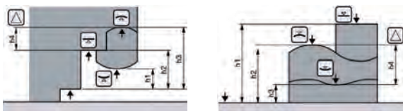
Messen ohne Wechsel der Messrichtung
